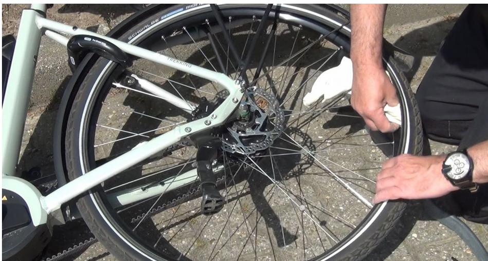
3. Fahrradmantel innen auf Fremdkörper untersuchen und reinigen.
