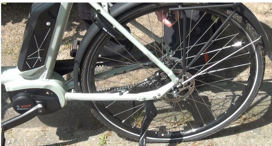
6. Das Fahrrad wieder aufrichten. Zum Aufpumpen muss das Ventil oben mittig sein, so dass das Gewicht auf dem platten Mantel lastet. Dies gewährleistet eine gleichmäßige Ausdehnung des Schlauches im Mantel
