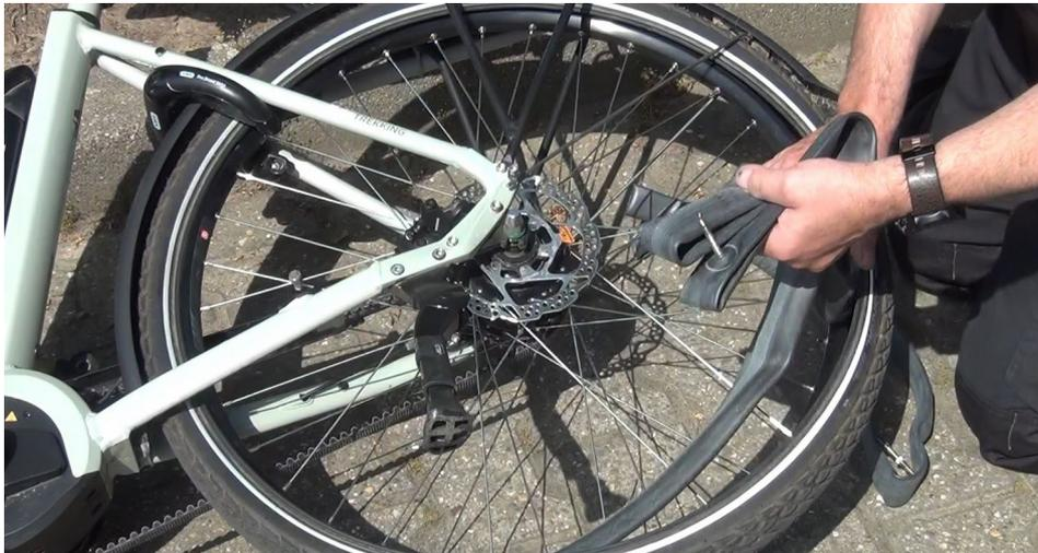
2. Defekten Schlauch entfernen.
