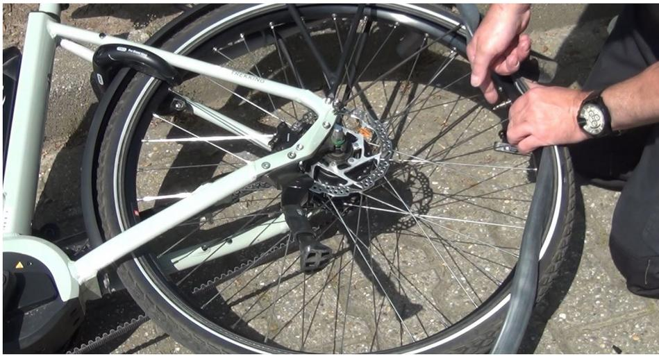
4. Den GAADI-Comfort unbefüllt montieren. Stecken Sie hierzu das Ventil in das Ventilloch und sichern Sie es durch leichtes Andrehen der Überwurfmutter. (Ca.  $\frac{1}{3}$  des Ventils)
