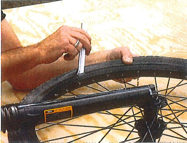
2. Den defekten herkömmlichen Fahrradschlauch aus dem Mantel entfernen.
