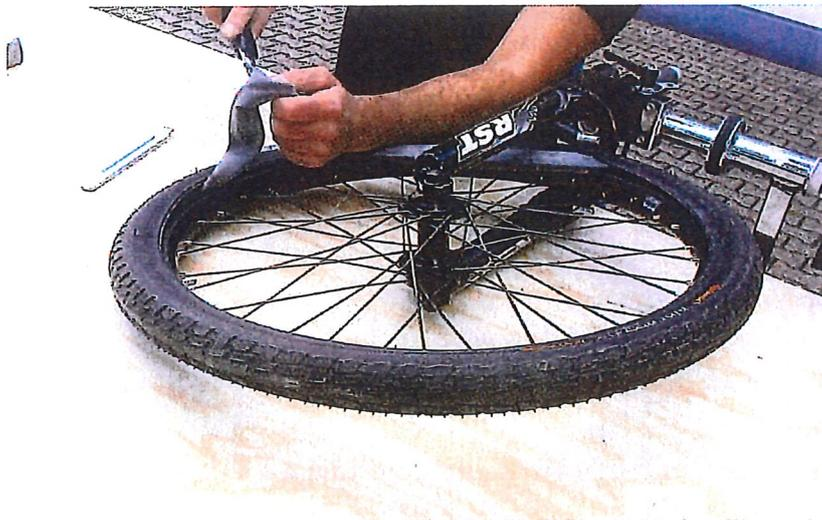
3. Den GAADI-Comfort Fahrradschlauch im unbefülltem Originalzustand (nicht vorab aufpumpen!!!) in den Mantel einlegen.
