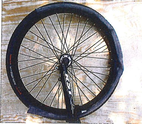
4. Den Fahrradmantel schließen. Unser empfohlener maximaler Druck ist 4,5 bar. Bei **schmäler Bereifung ( 37-622 bis 57-622)**, sicherstellen, dass sich der Schlauch nicht zwischen Felge und Mantel verklemmt; bitte entsprechend vorsichtig aufpumpen.
